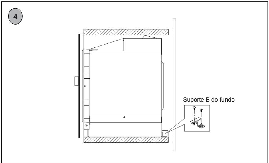
4 - O suporte do fundo está instalado apenas na parte de trás do aro de encastre do forno.
