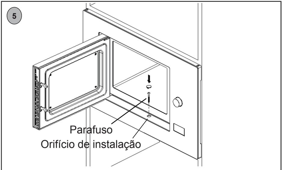
5 – Abra a porta e fixe o forno ao aro de encastre com o parafuso no orifício do kit da tampa.
