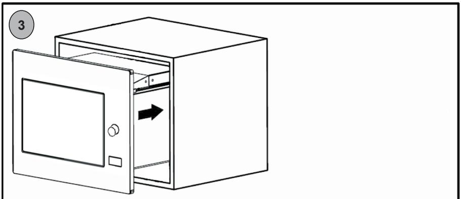
3 - Insira e instale o forno no espaço de encaixe já depois do aro colocado.
