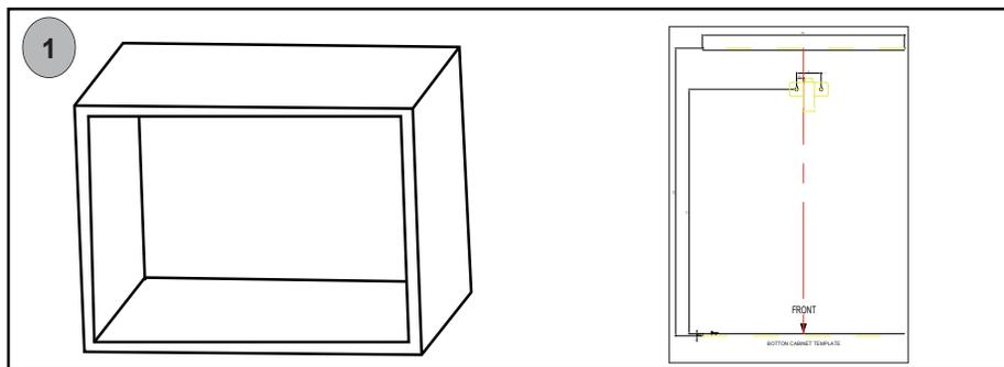
1 - Coloque o aro de encastre no fundo do armário em que o electrodoméstico vai ser encastrado. Depois faça a linha de centro do esquema coincidir com o fundo do armário.
