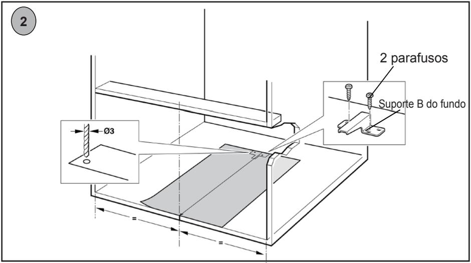
2 - Fixe o suporte do fundo com os 2 parafusos e depois pode remover o esquema do fundo.
