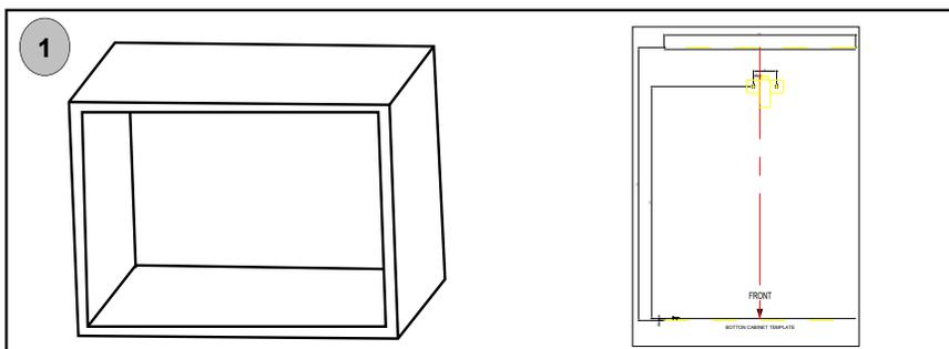
1. Appoggiare il modello inferiore della nicchia nel piano della interno della nicchia stessa e allineare il modello inferiore della nicchia con il piano inferiore della nicchia.
