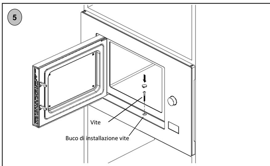
5. Aprire la porta; fissare il forno nella nicchia con la vite e coprire il buco di installazione con la guarnizione plastica.
