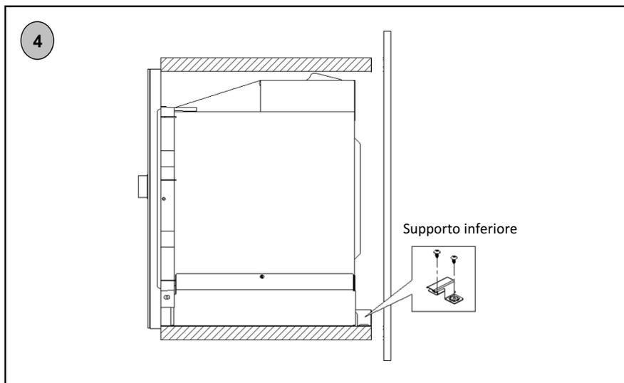
4. Il supporto inferiore deve essere installato contro la parte posteriore della struttura del forno.
