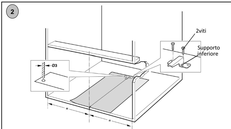
2. Fissare il supporto inferiore con le due viti e rimuovere il modello inferiore della nicchia.
