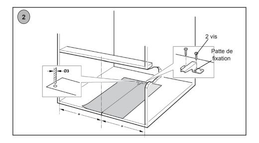
2. Fixer la patte de fixation avec les deux vis et enlever le gabarit installé précédement.
