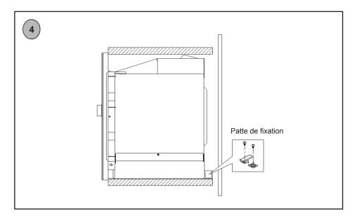
4. La patte de fixation est installée contre la paroi arrière du four
