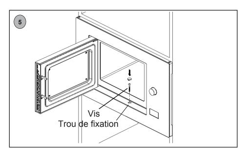
5. Ouvrir la porte, fixer le four au meuble avec la Vis par le trou de fixation. Puis mettre le cache plastique sur le trou de fixation.
