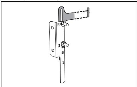
5. Alinee la base de la abrazadera de fijación hasta el suelo y apriete los tornillos para fijar las medidas.
