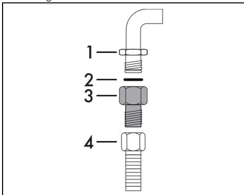
Enrosque cuidadosamente el manguito 3 en el manguito del gas 1 (rosca 1/2" ISO 228-1) del aparato intercalando siempre la junta 2 suministrada. Aplice material aislante en la rosca del manguito 3, luego enrosque el tubo flexible de acero 4 al manguito 3.
