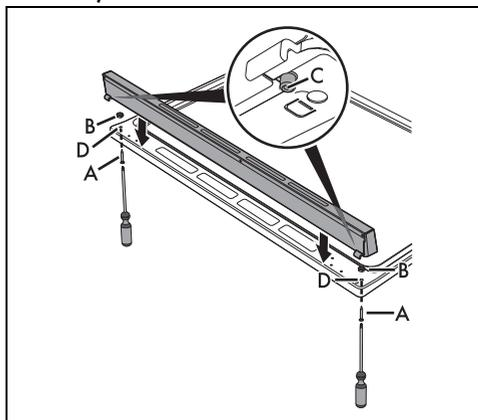
El respaldo debe estar siempre correctamente colocado y fijado en el aparato.
