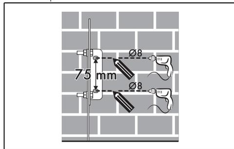
8. Después de haber hecho los agujeros en la pared, utilice tacos con tornillos para fijar la abrazadera a la pared.
