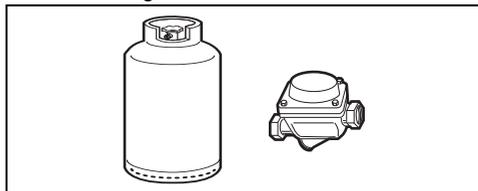
Utilice un regulador de presión y efectúe la conexión a la bombona de gas en conformidad con las disposiciones establecidas en las normas vigentes.
