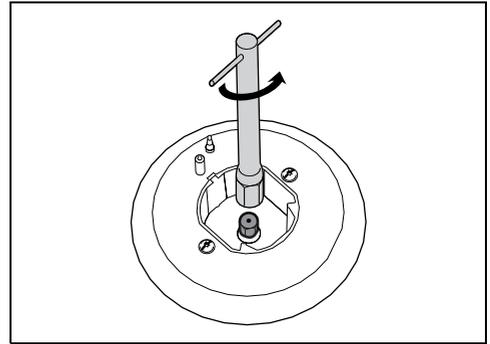
1. Retire las rejillas, las tapas y los difusores de llama de los quemadores para acceder a las tazas de los quemadores.
