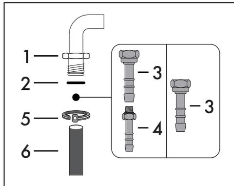
Enrosque cuidadosamente el conector de manguera 3 en el manguito del gas 1 (rosca 1/2" ISO 228-1) del aparato intercalando la junta 2. Según el diámetro del tubo del gas utilizado es posible enroscar también el conector de manguera 4 en el conector de manguera 3.
