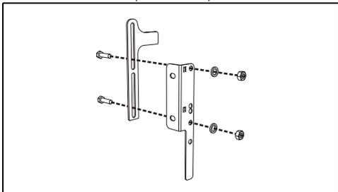
4. Alinee la base del gancho del soporte de fijación con la base del corte de la placa de fijación a la pared.
