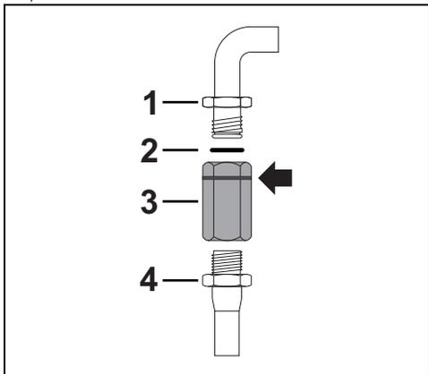
Aplice material aislante en la rosca del tubo del gas 4 y enrosque el adaptador 3. Enrosque el bloque al manguito móvil 1 del aparato interponiendo siempre la junta 2 que se suministra.
