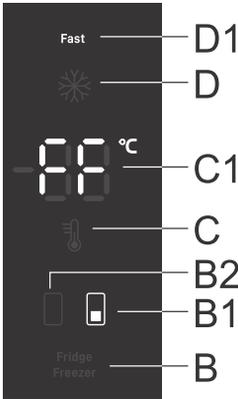
**Aktivierung:** drücken Sie die **D**-Taste, um die Funktion des intensiven Einfrierens (SuperFreeze) zu aktivieren. Sie hören einen Signalton und die Anzeigen **B1** und **D1** leuchten auf. **FF** erscheint auf dem Display **C1**. **FF** leuchtet, solange die Funktion aktiv ist, wenn die Anzeige **B1** mit der Taste **B** ausgewählt ist.
