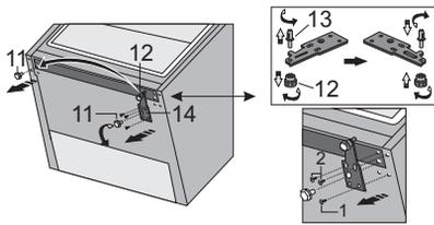
Lösen Sie die drei Schrauben des unteren Scharniers (14) und entfernen Sie es. Entfernen Sie den zusätzlichen Fuß (12) vom unteren Scharnierstift (13). Schrauben Sie den Stift (13) aus dem unteren Scharnier heraus und schrauben Sie ihn zusammen mit dem zusätzlichen Fuß (12) auf die gegenüberliegende Seite des Scharniers.
