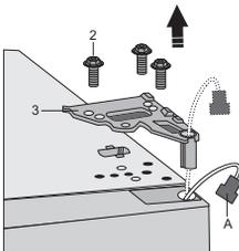
Lösen Sie die Schrauben (2) und entfernen Sie das Scharnier (3). Führen Sie den Steckverbinder (A) durch das Loch im Scharnier. Halten Sie die Tür dabei fest, damit sie nicht herunterfällt.
