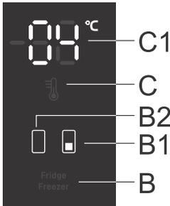
In diesem Modell können Sie zwischen der Einstellung der Temperatur des Kühlschranks und der Temperatur des Gefrierbehälters wechseln. Drücken Sie dazu die **B**-Taste. Das Symbol für den gewünschten Behälter leuchtet: **B1** für den Gefrierbehälter und **B2** für den Kühlbehälter.
