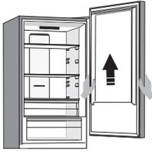
Entfernen Sie die obere Tür vom mittleren Scharnier, indem Sie die Tür vorsichtig nach oben anheben. Legen Sie die Gerätetür auf eine weiche Unterlage.
