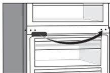
Entfernen Sie die mittlere Scharnierabdeckung und stecken Sie sie auf die gegenüberliegende Seite.
