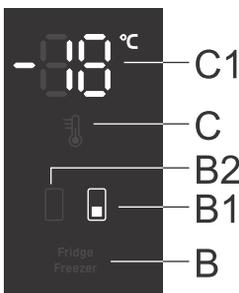
Die Temperatur im **Gefrierfach** kann eingestellt werden, sobald das Symbol **B1** aufleuchtet. Stellen Sie die gewünschte Temperatur durch kurzes Drücken der Taste **C** ein.
