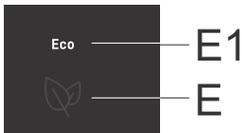
**Einschalten:** Um die **Eco** Funktion zu aktivieren, drücken Sie kurz die Taste **E**. Das Symbol **E1** leuchtet auf. Wenn diese Funktion aktiviert ist, arbeitet das Gerät unter optimalen Einstellungen.
