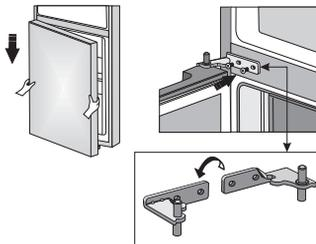
Setzen Sie die untere Tür auf das untere Scharnier und halten Sie sie fest. Drehen Sie das mittlere Scharnier um 180°. Bringen Sie die Unterlegscheibe in die richtige Position und stellen Sie die Position des mittleren Scharniers so ein, dass die untere Tür montiert und befestigt werden kann.
