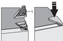
Entfernen Sie die obere Scharnierabdeckung (1).
