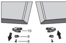
Legen Sie die untere Tür auf eine weiche Unterlage. Lösen Sie die Schraube (8) und entfernen Sie den Türhalter (10) und den Türanschlag (9). Verwenden Sie dann die Schraube (8), um den im Beutel enthaltenen Türhalter und Türanschlag (9) zu montieren. Bewahren Sie den Türhalter (10) für den Fall auf, dass Sie ihn später benötigen.
