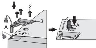
Positionieren Sie ordnungsgemäß die obere Tür, führen Sie den Steckverbinder (A) durch das Loch im oberen Scharnier (3) und befestigen Sie ihn mit den Schrauben (2). Halten Sie die obere Tür fest, während Sie diese positionieren. Verbinden Sie den Steckverbinder (A).
