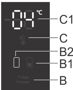
Die Temperatur im **Kühlteil** kann eingestellt werden, sobald das Symbol **B2** beleuchtet ist. Stellen Sie die gewünschte Temperatur durch kurzes Drücken der Taste **C** ein.
