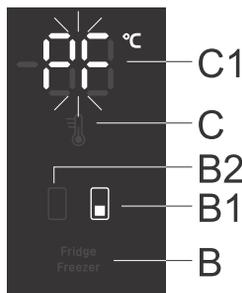
Falls die Temperatur im Gerät während eines Stromausfalls den Alarmwert erreicht, wird der Hochtemperaturalarm aktiviert, wenn die Stromversorgung wieder hergestellt wird. Ein akustischer Alarm ertönt und auf der Anzeige **C1** blinkt das Symbol **PF**.
