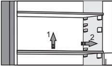
Sie können leere Ablagen nach Belieben über die Führungen im Kühlschrankinneren verlegen, ohne diese aus dem Kühlschrank nehmen zu müssen. Um die Ablage zu bewegen oder aus dem Kühlschrank zu nehmen, heben Sie sie hinten leicht an, ziehen Sie sie in Ihre Richtung und verlegen Sie sie oder nehmen Sie sie aus dem Gerät heraus. Lagern Sie schnell verderbliche Lebensmittel an der Rückseite des Innenraums, wo die Temperatur am niedrigsten ist.
