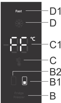
**Ausschalten:** wenn der Kühlbehälter aktiv ist (**B2**leuchtet), drücken Sie zuerst die **B**-Taste, um zum Gefrierbehälter zu wechseln (**B1** leuchtet auf), und drücken Sie dann die **D**-Taste, um die Funktion zu deaktivieren.
