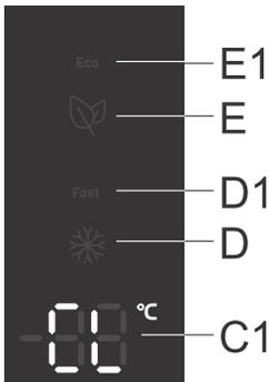
**Einschalten:** Um die Kindersicherung zu aktivieren, drücken Sie die **E**-Taste und halten Sie diese eine Weile (3 Sekunden) gedrückt. **CL** erscheint kurz auf der **C1**-Anzeigeeinheit angezeigt.
