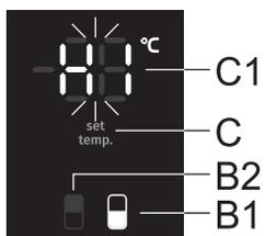
Falls die Temperatur im Gerät zu hoch ist, wird ein akustischer Alarm ausgelöst (intermittierendes akustisches Signal). Auf der Anzeige **C1** blinkt das Symbol **HI** und das Symbol für den Teil, in dem die Temperatur zu hoch ist (**B1** oder **B2**) leuchtet auf.
