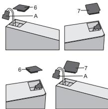
Entfernen Sie die Abdeckung (6) von der linken Seite der oberen Tür und lösen Sie den Steckverbinder. Entfernen Sie danach die Abdeckung (7) von der rechten Seite der oberen Tür. Platzieren Sie die Abdeckung (7) auf die linke Seite der oberen Tür und die Abdeckung (6) auf die rechte Seite der oberen Tür.
