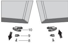
Posez la porte inférieure sur une surface lisse. Enlevez la vis (8) et retirez le rétenteur de porte (10) et la butée (9). Fixez ensuite le rétenteur de porte fourni dans le sachet et la butée (9) avec la vis (8). Conservez le rétenteur de porte (10) au cas où vous en auriez besoin ultérieurement.
