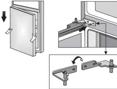
Positionnez la porte inférieure sur la charnière inférieure et maintenez-les en place. Faites pivoter la charnière centrale de 180°. Placez la rondelle dans la bonne position et ajustez la position de la charnière centrale de façon à pouvoir installer et fixer la porte inférieure.
