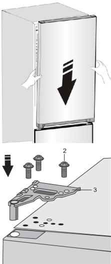
Placez la porte supérieure dans la position correcte et fixez la charnière supérieure (3) avec les vis (2). Maintenez la porte supérieure en place pendant que vous les positionnez.
