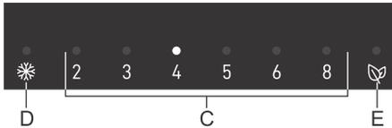
Les chiffres 2, 3, 4, 5, 6 et 8 indiquent la température en degrés Celsius (°C) dans le compartiment réfrigérateur.
