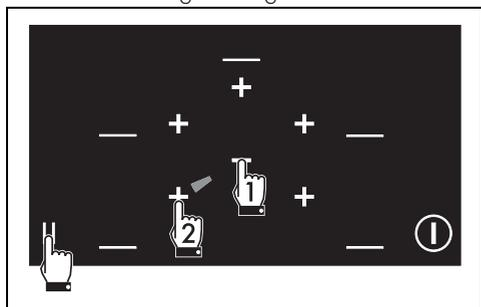
Nun wurde der Zugriff auf das technische Menü durchgeführt und die Tasten können losgelassen werden. Das Display vorne links zeigt den Code an, der die Option unterscheidet: es
