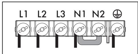
Fünfpoliges Kabel 5 x 1,5 mm<sup>2</sup>.
