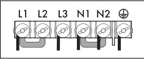
Fünfpoliges Kabel 5 x 4 mm<sup>2</sup>.
