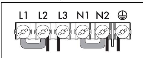
cable de cuatro polos  $4 \times 4 \text{ mm}^2$ .
