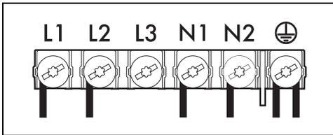
Cable de seis polos  $6 \times 1,5 \text{ mm}^2$ .
