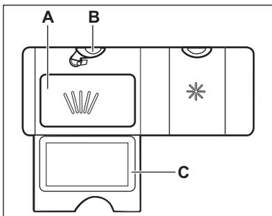
1. Appuyez sur le bouton de déverrouillage (B) pour ouvrir le couvercle (C).
