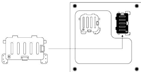
Appoggiare le linguette del coperchio B sul pannello inferiore. Completare il montaggio ruotando il coperchio.
