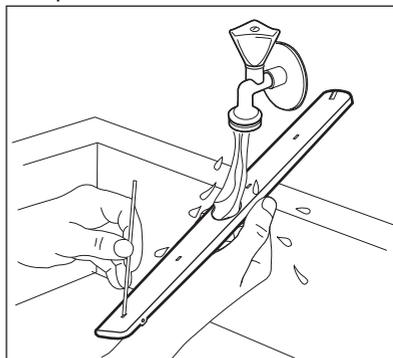
5. Per re-installare il mulinello (C), inserire l'elemento di montaggio (B) nel mulinello e fissarlo nel tubo di erogazione (A) ruotandolo in senso orario. Assicurarsi che l'elemento di montaggio si blocchi in posizione.
