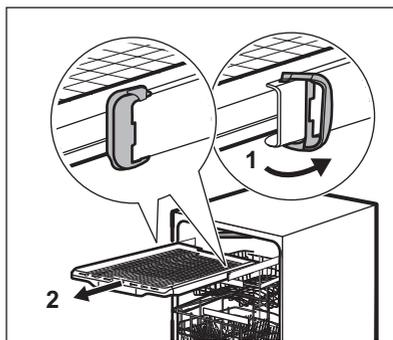
2. Spostare il cestello superiore sul livello inferiore per raggiungere il mulinello superiore con maggiore facilità.
