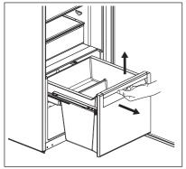
Repoussez les rails vers l'intérieur de l'appareil pour éviter de l'endommager lors de la fermeture de la porte.
