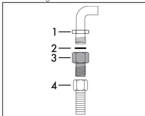
Avvitare accuratamente il raccordo 3 al raccordo gas 1 (filetto  $\frac{1}{2}$ " ISO 228-1) dell'apparecchio interponendo sempre la guarnizione 2 in dotazione. Applicare del materiale isolante sul filetto del raccordo 3, dopodiché avvitare il tubo flessibile in acciaio 4 al raccordo 3.
