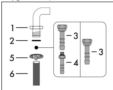
Avvitare accuratamente il portagomma 3 al raccordo gas 1 (filetto  $\frac{1}{2}$ " ISO 228-1) dell'apparecchio interponendo la guarnizione 2. A seconda del diametro del tubo gas utilizzato è possibile avvitare anche il portagomma 4 al portagomma 3.
