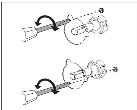
Accendere il bruciatore e portarlo sulla posizione minima. Estrarre la manopola del rubinetto gas e agire sulla vite di regolazione a lato dell'astina del rubinetto (a seconda dei modelli), fino ad ottenere una fiamma minima regolare.
