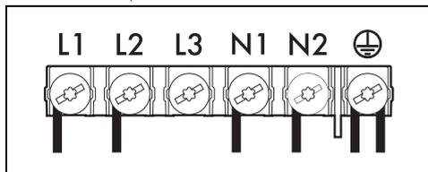
Cabo de seis polos  $6 \times 1,5 \text{ mm}^2$ .
