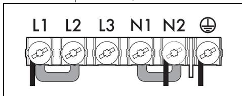
Cabo de três polos  $3 \times 6 \text{ mm}^2$ .
