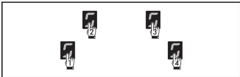
Appuyez en séquence sur toutes les touches en partant de la zone avant gauche (1) dans le sens des aiguilles d'une montre. Chaque pression est confirmée par un signal sonore.
