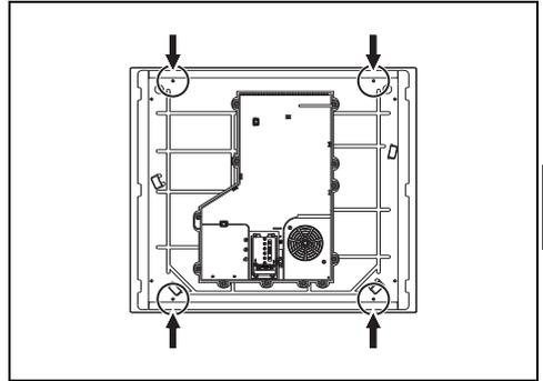
2. Die Befestigungsbügel (A) in die gekennzeichneten Löcher der zuvor entfernten Schrauben einschrauben, um das Kochfeld an der Struktur zu befestigen.
