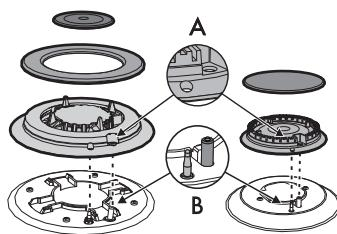
Перед тем, как включить конфорки варочной поверхности, убедитесь, что корончатые рассекатели и крышки на них установлены в соответствующих пазах. Следите за тем, чтобы отверстия «1» рассекателей совпадали со свечами «3» и термопарами
