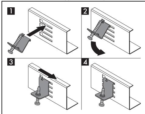
3. Расположите варочную панель на изолирующей прокладке и, с помощью винтов и крепежных кронштейнов (A) из комплекта, закрепите панель на опорной
