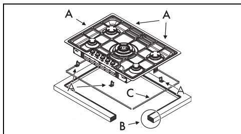
Эта встраиваемая модель требует выполнения на столешнице отверстия глубиной 3 мм (деталь "B" на рисунке выше). Прежде чем устанавливать прибор, следует поместить на отверстие изолирующую
