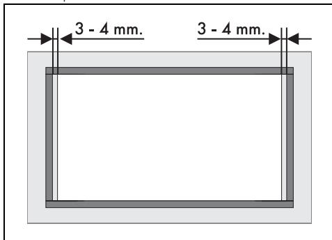
2. Приклейте, слегка нажимая, прокладку на поверхность внешнего периметра отверстия столешницы. При этом передний и задний край прокладки должны быть на уровне отверстия.
