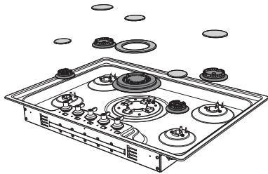
3. Трубчатым ключом на 7 мм раскрутите форсунки конфорок и замените их согласно используемому типу газа (см. "Таблицы с характеристиками конфорок и форсунок").
