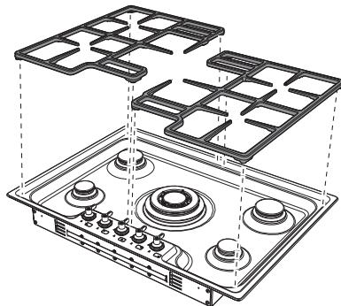
Удостоверьтесь, что решетки были просто отцентрированы на соответствующих конфорках, чтобы они не находились в приподнятом или наклоненном положении; в противном случае следует повторить их установку.
