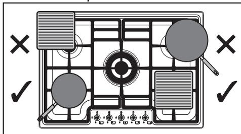
Durante la cottura, per evitare scottature, danni al piano o al top, tutti i recipienti o le bisticchiere devono essere posizionati all'interno del perimetro del piano di cottura.
