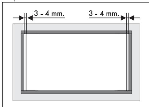
2. Farla aderire, con una leggera pressione, sulla superficie del perimetro esterno del foro praticato nel piano top; i lati anteriore e posteriore della guarnizione devono essere radenti al foro.
