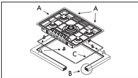
Questo modello di incasso necessita di una fresatura sul piano top di profondità pari a 3 mm (particolare "B" della figura soprastante). Prima di posizionare l'apparecchio, occorre applicare sulla fresatura la guarnizione isolante in dotazione (C).
