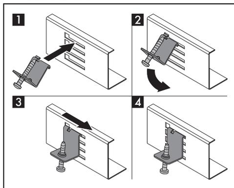
3. Appoggiare il piano sulla guarnizione isolante e mediante le viti e le staffe di fissaggio in dotazione (A), fissare il piano
