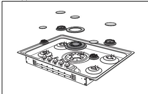
3. Con una chiave a tubo di 7 mm svitare gli ugelli dei bruciatori e procedere alla sostituzione degli stessi secondo il gas da impiegare (Vedi "Tabelle caratteristiche bruciatori e ugelli").
