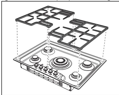
Asegúrese de que las rejillas estén simplemente centradas sobre sus respectivos quemadores sin forzarlas a quedar levantadas o inclinadas; en tal caso repita la colocación.
