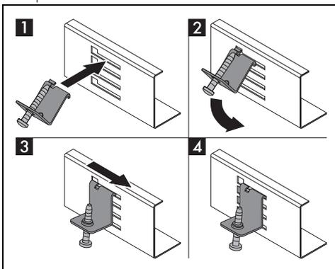
3. Apoye la encimera sobre la junta aislante y mediante los tornillos y las abrazaderas de fijación suministradas (A), fije la encimera a
