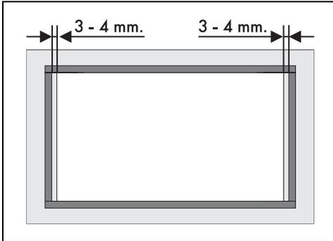
2. Adhiérala, con una ligera presión, a la superficie del perímetro exterior del orificio perforado en la encimera; los lados delantero y trasero de la junta deben quedar al ras del orificio.
