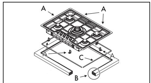
Este modelo de empotrado exige cortar la encimera superior a una profundidad de 3 mm (elemento «B» de la figura anterior). Antes de colocar el aparato, es necesario cortar la junta aislante suministrada (C).
