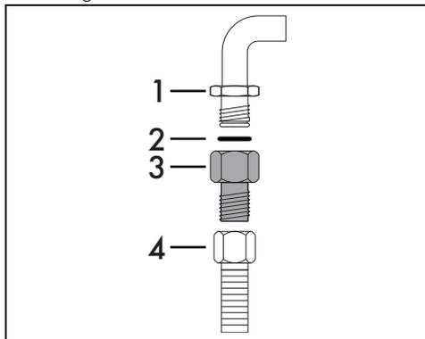
Enrosque cuidadosamente el manguito 3 en el manguito del gas 1 (rosca 1/2" ISO 228-1) del aparato intercalando siempre la junta 2 suministrada. Aplique material aislante en la rosca del manguito 3, luego enrosque el tubo flexible de acero 4 al manguito 3.
