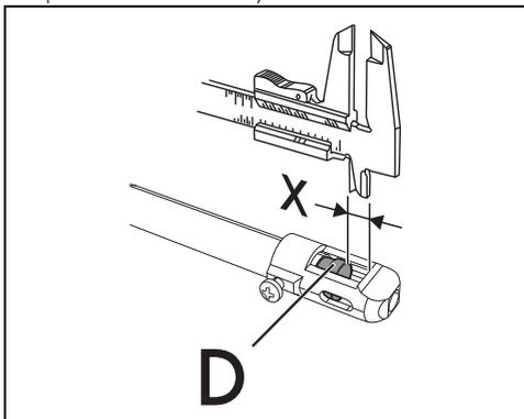
10. Ajuste la entrada de aire desplazando el tubo Venturi "D", hasta obtener la distancia "X" que figura en las tablas correspondientes (vea "Tabla de características de los quemadores e inyectores", en la opción "Aire primario (mm)"); a continuación, apriete el tornillo "A".
