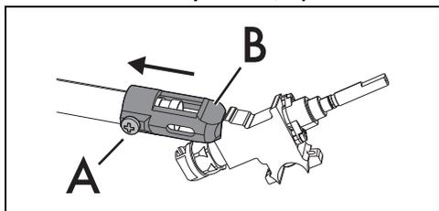
7. Afloje el tornillo "A" y empuje hasta el fondo el regulador del aire "B".
