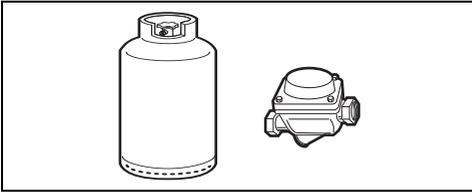
Einen Druckregler verwenden und den Anschluss an die Gasflasche unter Einhaltung der von der gültigen Gesetzgebung festgelegten Richtlinien ausführen.
