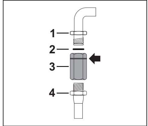
Auf das Gewinde des Gasversorgungsschlauchs 4 ein Isoliermaterial auftragen und den Adapter 3 anschrauben. Schrauben Sie den Block an den beweglichen Anschluss 1 des Gerätes. Legen Sie dabei die mitgelieferte Dichtung 2 zwischen die Baugruppe und den Anschluss.
