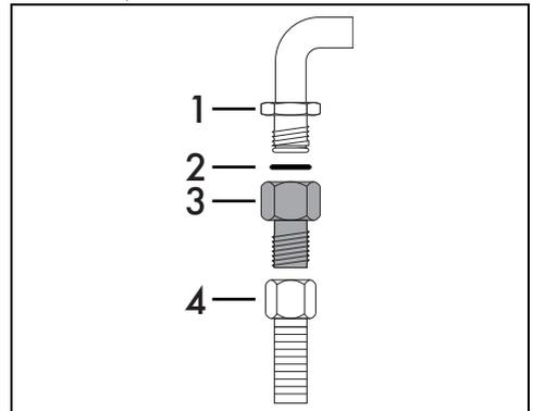
Den Anschluss 3 fest auf den Gasanschluss 1 (Gewinde  $\frac{1}{2}$ " ISO 228-1) des Gerätes schrauben. Auch hier die mitgelieferte Dichtung 2 zwischen die beiden Anschlüsse legen. Isoliermaterial an dem Gewinde des Anschlusses 3 anbringen und dann den Stahlschlauch 4 an dem Anschluss 3
