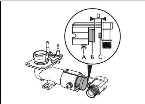
1. Die Schraube A lösen und den Luftregler B bis zum Anschlag drücken.
