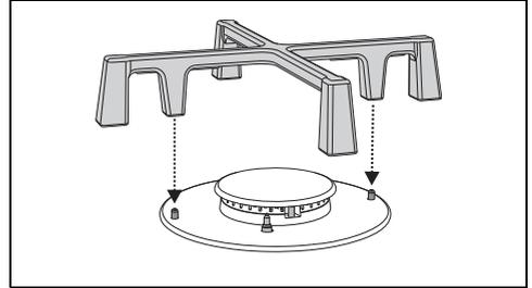
Sicherstellen, dass die Roste auf die entsprechenden Brenner zentriert sind, ohne sie angehoben sind oder schief liegen; ist dieses der Fall, muss eine erneute Positionierung vorgenommen werden.
