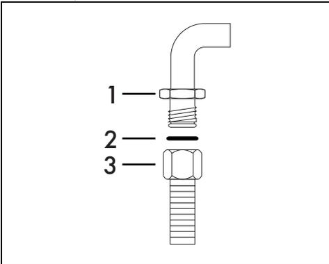
Den Anschluss 3 korrekt auf den Gasanschluss 1 des Gerätes schrauben. Zwischen dem Anschluss und dem Gasanschluss immer die mitgelieferte Dichtung 2 einsetzen.
