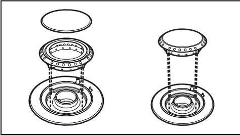
Vor dem Zünden der Brenner ist sicherzustellen, dass die Brennerkränze mit den zugehörigen Brennerdeckeln richtig in ihren Sitzen positioniert sind. Darauf achten, dass die Öffnungen der Brenner mit den Zündkerzen und den Thermoelementen übereinstimmen. Zudem muss sichergestellt werden, dass die Einsätze der Kronenbrenner richtig in die Brenneröffnungen eingesetzt werden.
