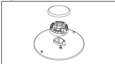
Avant d'allumer les brûleurs du plan de cuisson, assurez-vous que les couronnes sont bien en place dans leurs logements avec leurs chapeaux. Veillez à ce que les orifices des brûleurs soient bien en face des bougies et des thermocouples. Contrôlez également que les ergots des couronnes s'insèrent correctement dans les orifices du brûleur.
