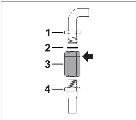
Appliquez du matériau isolant sur le filetage du tuyau de gaz 4 avant d'y visser l'adaptateur 3. Vissez le bloc sur le raccord mobile 1 de l'appareil en interposant toujours le joint 2 fourni.
