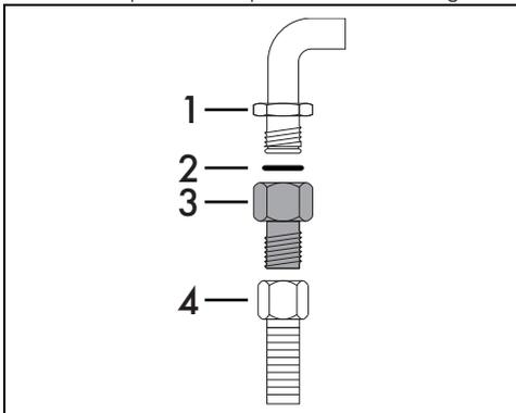
Vissez soigneusement le raccord 3 au raccord du gaz 1 (fileté 1/2" ISO 228-1) de l'appareil en interposant toujours le joint 2 fourni. Appliquez du matériau isolant sur le filetage du raccord 3, puis vissez le tuyau flexible en acier 4 au raccord 3.
