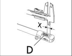
10. Ajuste la entrada de aire desplazando el tubo Venturi "D", hasta obtener la distancia "X" que figura en las tablas correspondientes (vea "Tabla de características de los quemadores e inyectores", en la opción "Aire primario (mm)"); a continuación, apriete el tornillo "Α".
