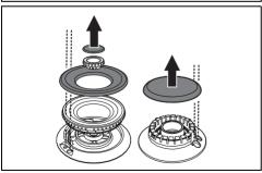
Antes de encender los quemadores de la encimera, verifique que los difusores de llama estén colocados en sus alojamientos con sus tapas correspondientes. Controle que los agujeros del quemador coincidan con las bujías y los termopares. Controle además que los acoples de los difusores de llama se introduzcan correctamente en los agujeros del quemador.
