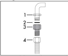
Enrosque cuidadosamente el manguito 3 en el manguito del gas 1 (rosca ½" ISO 228-1) del aparato intercalando siempre la junta 2 suministrada. Aplique material aislante en la rosca del manguito 3, luego enrosque el tubo flexible de acero 4 al manguito 3.
