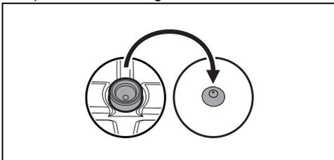
Sob as grelhas encontram-se dispositivos em silicone côncavos para centrar no respetivo perno de fixação situado na placa.
