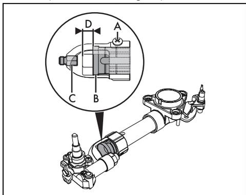
7. Desaperte os parafusos "A" e empurre a fundo o regulador de ar "B".
