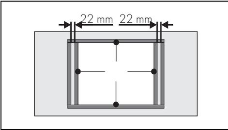
2. Faça-a aderir, com uma ligeira pressão, à superfície do perímetro externo do furo realizado em cima da placa.
