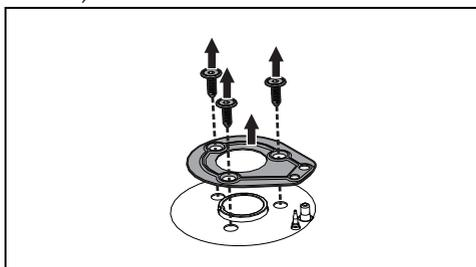
5. Retire a junta presente nos termopares e velas de cada queimador.
