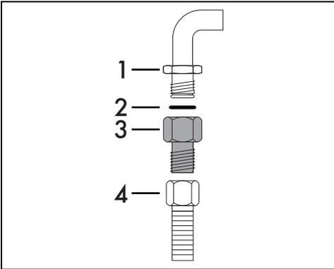
Enrosque cuidadosamente el manguito 3 en el manguito del gas 1 (rosca 1/2" ISO 228-1) del aparato intercalando siempre la junta 2 suministrada. Aplique material aislante en la rosca del manguito 3, luego enrosque el tubo flexible de acero 4 al manguito 3.
