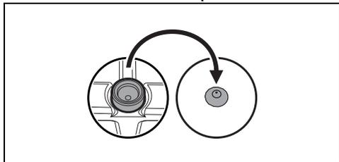
Debajo de las rejillas hay almohadillas de silicona cóncavas que se colocan en el relativo perno de fijación de la encimera.
