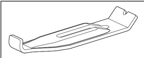
Enrosque las abrazaderas de fijación en los orificios correspondientes para fijar correctamente la encimera de cocción a la
