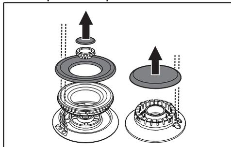
Antes de encender los quemadores de la encimera, verifique que los difusores de llama estén colocados en sus alojamientos con sus tapas correspondientes. Controle que los agujeros del quemador coincidan con las bujías y los termopares. Controle además que los acoples de los difusores de llama se introduzcan correctamente en los agujeros del quemador.
