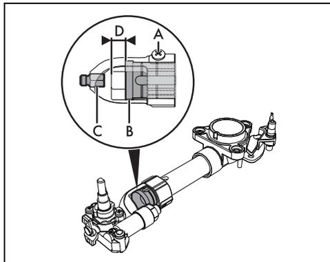
7. Afloje el tornillo "A" y empuje hasta el fondo el regulador del aire "B".
