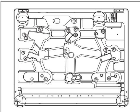
Die Befestigungsbügel in die markierten Löcher schrauben, um das Kochfeld ordnungsgemäß an der Einbaustruktur zu befestigen.
