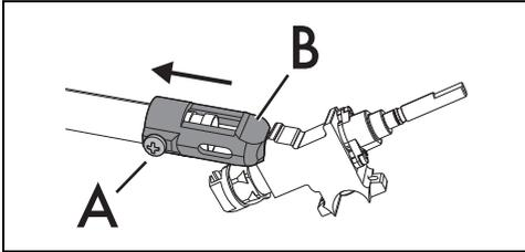
6. Die Schraube „A“ lösen und den Luftregler „B“ bis zum Anschlag drücken.
