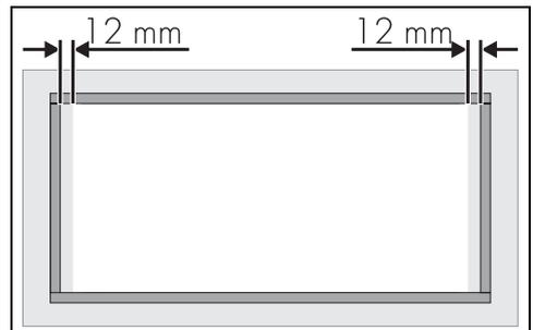
2. Durch Ausüben eines leichten Drucks die Dichtung entlang des in der Arbeitsfläche realisierten Aussparung auf der Oberfläche anbringen.
