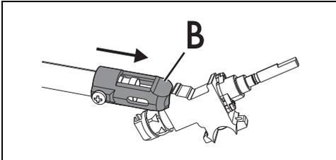
8. Die Halterung „B“ wieder in Ausgangsstellung bringen, so dass die Düse „C“ vollständig abgedeckt ist.
