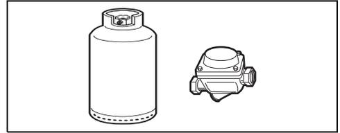
Einen Druckregler verwenden und den Anschluss an die Gasflasche unter Einhaltung der von der gültigen Gesetzgebung festgelegten Richtlinien ausführen.
