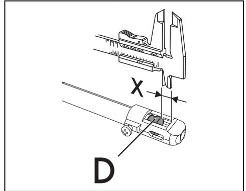
9. Zur Nachstellung der Luft das Venturirohr „D“ verschieben, bis der in den entsprechenden Tabellen angegebene Abstand „X“ erreicht ist (siehe Tabelle „Eigenschaften der Brenner und Düsen“, in der Spalte „Primärluft (mm)“); danach die Schraube „A“ festziehen.
