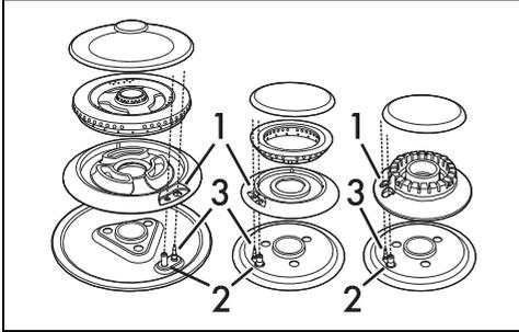
Vor dem Zünden der Brenner ist sicherzustellen, dass die Brennerkränze mit den zugehörigen Brennerdeckeln richtig in ihren Sitzen positioniert sind. Darauf achten, dass die Öffnungen 1 der Brennerkränze, die Zündkerzen 3 und die Thermoelemente 2 aneinander ausgerichtet sind. Zudem muss sichergestellt werden, dass die Einsätze der Brennerkränze richtig in die Brenneröffnungen eingesetzt werden.
