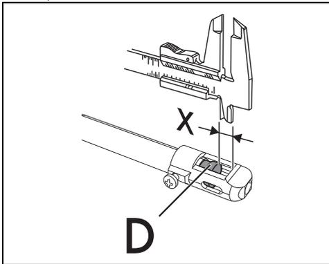
9. Réglez l'arrivée d'air en déplaçant le tube Venturi « D » jusqu'à obtenir la distance « X » indiquée dans les tableaux respectifs (voir le Tableau des caractéristiques des brûleurs et des injecteurs » au paragraphe « Air primaire (mm) ») ; serrez ensuite la vis « A ».
