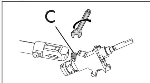
7. Avec une clé fixe, démontez les injecteurs C et montez ceux indiqués pour le nouveau type de gaz, en suivant les indications figurant dans les tableaux correspondants (voir « Types de gaz et pays d'appartenance »).
