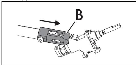
8. Remplacez le support « B » dans la position initiale de manière à couvrir parfaitement l'injecteur « C ».
