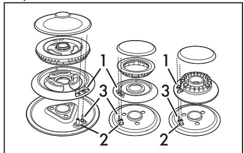
Avant d'allumer les brûleurs de la plaque de cuisson, assurez-vous que les couronnes sont bien en place dans leurs logements avec leurs chapeaux. Veillez à ce que les orifices 1 des couronnes correspondent aux bougies 3 et aux thermocouples 2. Contrôlez également que les embayages des couronnes pénètrent correctement à l'intérieur des orifices du brûleur.
