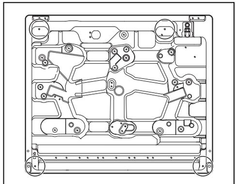
Vissez les pattes de fixation dans les trous marqués pour fixer correctement la table de cuisson à la structure encastrée.
