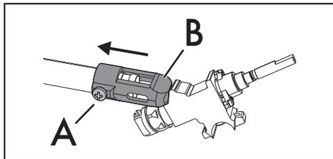
6. Desserrez la vis « A » et poussez à fond le régulateur d'air « B ».
