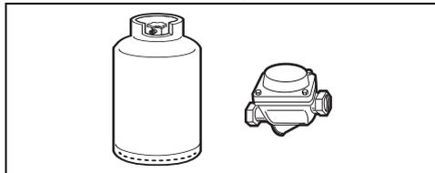
Utilisez un régulateur de pression et réalisez le raccordement à la bouteille conformément aux prescriptions établies par les normes en vigueur. La pression d'alimentation doit respecter les valeurs indiquées dans les « Tableaux des caractéristiques des brûleurs et injecteurs ».
