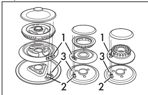
Avant d'allumer les brûleurs de la plaque de cuisson, assurez-vous que les couronnes sont bien en place dans leurs logements avec leurs chapeaux. Veillez à ce que les orifices 1 des couronnes correspondent aux bougies 3 et aux thermocouples 2. Contrôlez également que les embrayages des couronnes pénètrent correctement à l'intérieur des orifices du brûleur.
