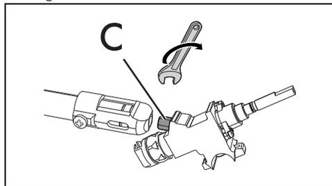
8. Avec une clé fixe, démontez les injecteurs C et montez ceux indiqués pour le nouveau type de gaz, en suivant les indications figurant dans les tableaux correspondants (voir « Types de gaz et pays d'appartenance »).
