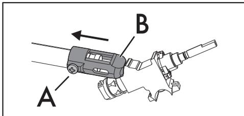
7. Desserrez la vis « A » et poussez à fond le régulateur d'air « B ».
