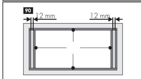
2. Faites-le adhérer par une légère pression sur la surface du périmètre externe du trou réalisé dans le plan de travail.
