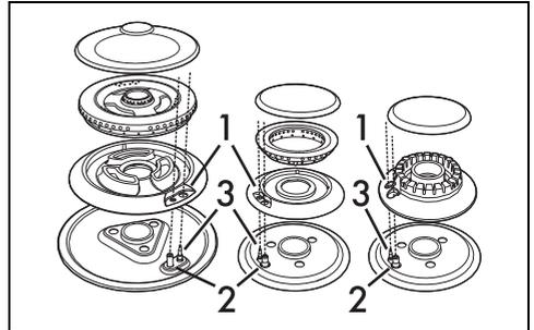
Avant d'allumer les brûleurs de la plaque de cuisson, assurez-vous que les couronnes sont bien en place dans leurs logements avec leurs chapeaux. Veillez à ce que les orifices 1 des couronnes correspondent aux bougies 3 et aux thermocouples 2. Contrôlez également que les embrayages des couronnes pénètrent correctement à l'intérieur des orifices du brûleur.
