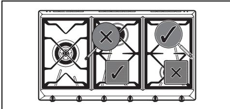
Pendant la cuisson, pour éviter des brûlures, des dommages à la table de cuisson ou au plan de travail, tous les récipients ou les poêles à steak doivent être positionnés dans le périmètre
