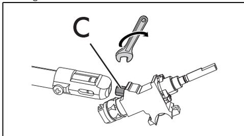
8. Avec une clé fixe, démontez les injecteurs C et montez ceux indiqués pour le nouveau type de gaz, en suivant les indications figurant dans les tableaux correspondants
