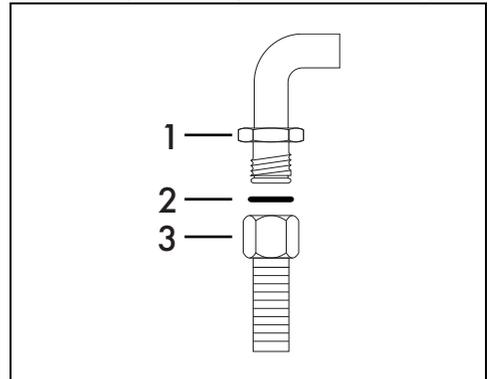
Vissez soigneusement le raccord 3 au raccord du gaz 1 de l'appareil en interposant toujours le joint 2 fourni.
