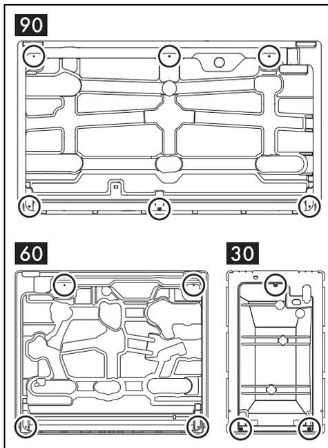
Vissez les pattes de fixation dans les trous marqués pour fixer correctement la table de cuisson à la structure encastrée.
