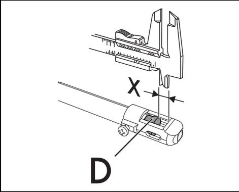
10. Réglez l'arrivée d'air en déplaçant le tube Venturi « D » jusqu'à obtenir la distance « X » indiquée dans les tableaux respectifs (voir le Tableau des caractéristiques des brûleurs et des injecteurs » au paragraphe « Air primaire (mm) ») ; serrez ensuite la vis « A ».
