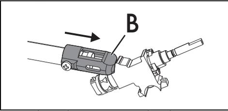
9. Remplacez le support « B » dans la position initiale de manière à couvrir parfaitement l'injecteur « C ».
