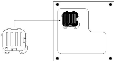
Inclinare leggermente la lavatrice all'indietro. Appoggiare le linguette del coperchio A sul pannello inferiore. Completare il montaggio ruotando il coperchio.
