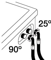
Collegare gli speciali tubi di ingresso dell'acqua di rete forniti con il prodotto agli ingressi dell'acqua sul prodotto. Il tubo rosso stampato (a sinistra) (max. 90 °C) è per l'ingresso dell'acqua calda, il tubo blu stampato (a destra) (max. 25 °C) è per l'ingresso dell'acqua fredda.
