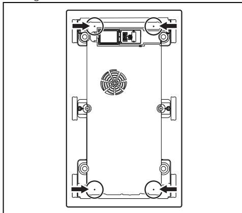
2. Avvitare le staffe di fissaggio (A) nei fori evidenziati con le viti rimosse in precedenza, per fissare correttamente il piano cottura alla struttura.
