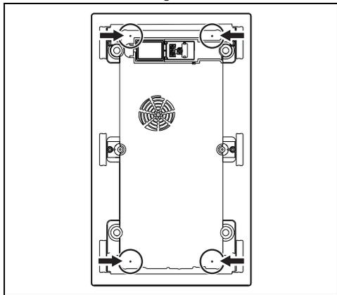
2. Vissez les pattes de fixation (A) dans les trous indiqués au moyen des vis enlevées précédemment pour fixer correctement la plaque de cuisson à la structure.
