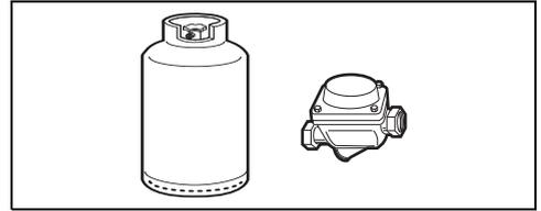
Utilizzare un regolatore di pressione e realizzare il collegamento sulla bombola nel rispetto delle prescrizioni stabilite dalle norme vigenti.
