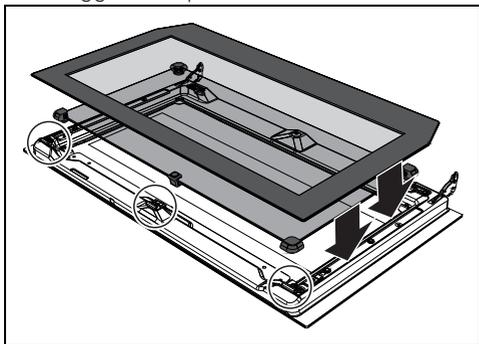
7. Per riposizionare il vetro interno, infilare la parte anteriore nelle clip della porta ed incastrare i 2 perni posteriori nelle loro sedi mediante una leggera pressione.
