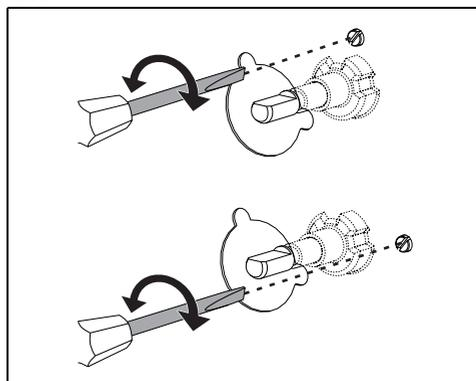
Accendere il bruciatore e portarlo sulla posizione minima. Estrarre la manopola del rubinetto gas e agire sulla vite di regolazione a lato dell'astina del rubinetto (a seconda dei
