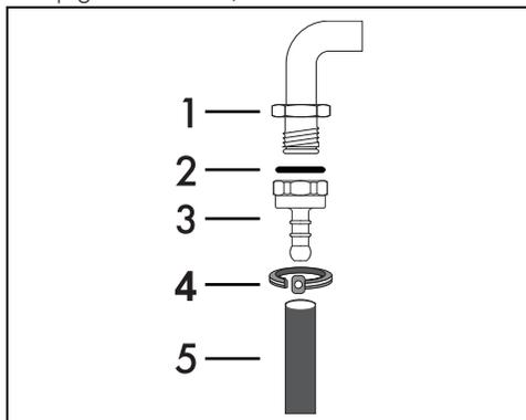
Avvitare accuratamente il portagomma 3 al raccordo gas 1 (filetto 1/2" ISO 228-1) dell'apparecchio interponendo la guarnizione 2. Dopo aver avvitato il portagomma calzare il tubo gas 5 sul di esso e fissarlo con la fascetta 4 conforme alla norma vigente.
