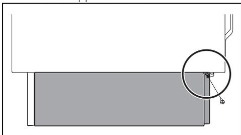
5. Fissare lo zoccolo laterale all'apparecchio tramite la vite precedentemente rimossa.
