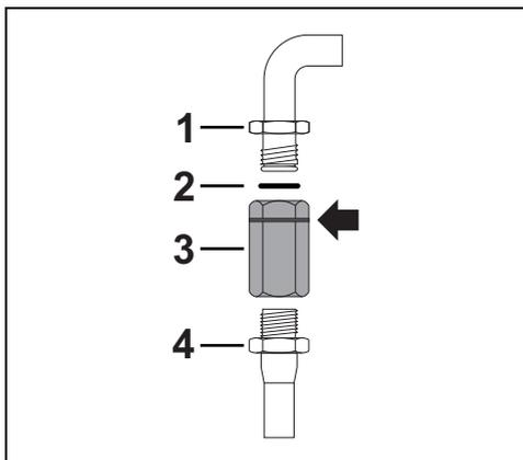
Applicare del materiale isolante sul filetto del tubo gas 4 ed avvitarsi l'adattatore 3. Avvitare il blocco al raccordo mobile 1 dell'apparecchio interponendo sempre la guarnizione 2 in dotazione.
