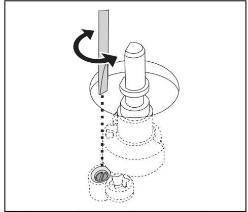
3. Rimontare la manopola e verificare la stabilità della fiamma del bruciatore.
