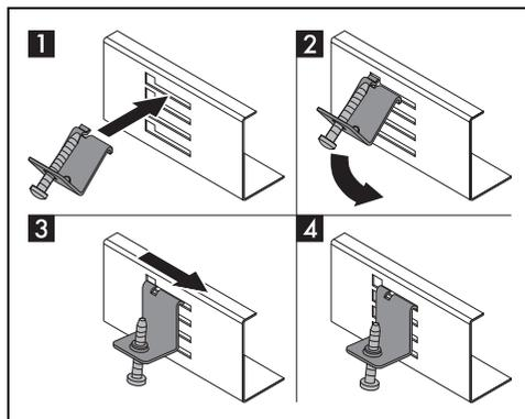
3. Appoggiare il piano sulla guarnizione isolante e mediante le viti e le staffe di fissaggio in dotazione (A), fissare il piano alla struttura di sostegno fino ad ottenere la perfetta planarità.
