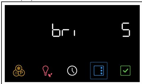
2. Ruotare la manopola temperatura a destra o a sinistra per selezionare la luminosità desiderata, dal valore 1 (bassa luminosità) al valore 5 (alta luminosità).
