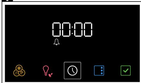
2. Ruotare la manopola temperatura per impostare la durata del contaminuti (da 1 minuto fino a 23 ore).
