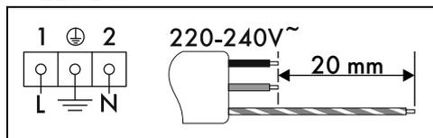
Cavo tripolare 3 x 2,5 mm<sup>2</sup>.
