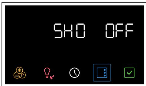
2. Ruotare la manopola temperatura per attivare la funzione show room.
