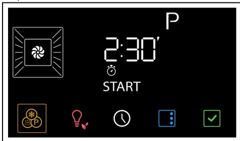
3. Ruotare la manopola temperatura per impostare la durata della Pirolisi da un minimo di 2:00 ore fino ad un massimo di 3:00 ore.
