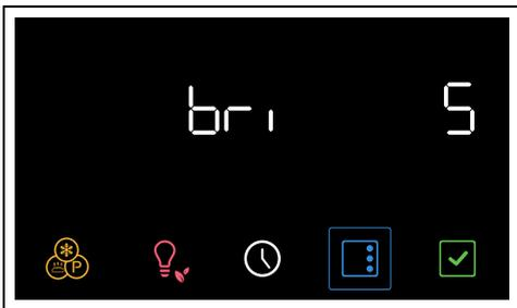
2. Tournez la manette température à droite ou à gauche pour sélectionner la luminosité souhaitée, de la valeur 1 (basse luminosité) à la valeur 5 (haute luminosité).
