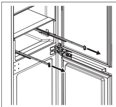
2. Coloque la parte trasera del cajón (1) sobre los rieles.
