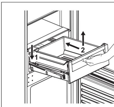
3. Mantenga la parte delantera del cajón (2) levantada mientras empuja el cajón hacia dentro.
