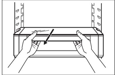
2. Incline hacia abajo el módulo para extraerlo del refrigerador.
