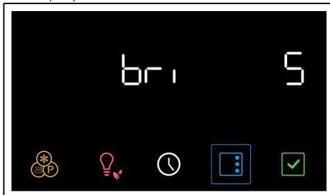
2. Ruotare la manopola temperatura a destra o a sinistra per selezionare la luminosità desiderata, dal valore 1 (bassa luminosità) al valore 5 (alta luminosità).
