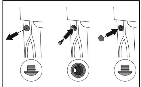
1. Die Stöpsel der Buchsen an der Vorderseite des Gerätes entfernen.
