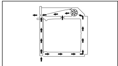
Der Lüfter kühlt das Gerät ab und setzt sich während des Garvorgangs in Betrieb.
