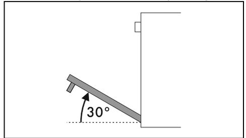
3. Para volver a montar la puerta coloque las bisagras en las hendiduras correspondientes situadas en el horno asegurándose de que las ranuras **A** se apoyen completamente en las hendiduras.
