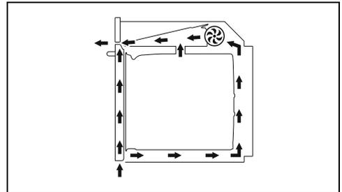
El ventilador procede a enfriar el aparato y entra en funcionamiento durante la cocción. El funcionamiento del ventilador crea un flujo de aire normal que sale por arriba de la puerta y puede seguir saliendo durante un breve período aun después de apagar el aparato.
