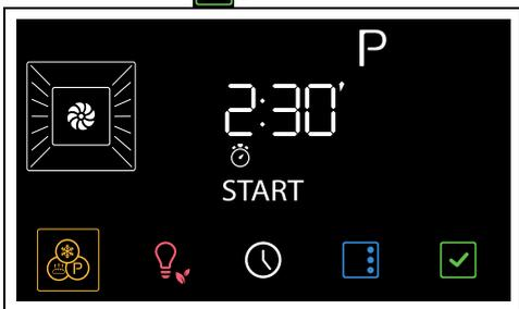
En la pantalla aparece la duración de la pirólisis (programada de fábrica en 2:30 horas).
