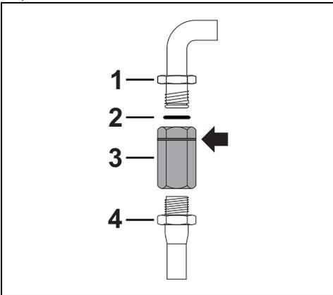
Aplique material aislante en la rosca del tubo del gas 4 y enrosque el adaptador 3. Enrosque el bloque al manguito móvil 1 del aparato interponiendo siempre la junta 2 que se suministra.
