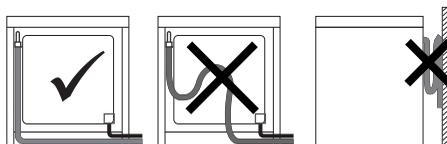
Eseguire il collegamento alla rete del gas utilizzando un tubo in gomma conforme alle caratteristiche indicate dalla norma vigente (verificare che la sigla di tale norma sia stampigliata sul tubo).
