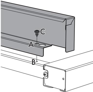
Fissare l'alzatina al pianale avvitando le viti **C**.
