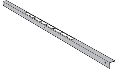
Mediante le 3 viti in dotazione, fissare il listello al pianale dell'apparecchio dapprima con la vite centrale (**1**), e poi con quelle laterali (**2**).
