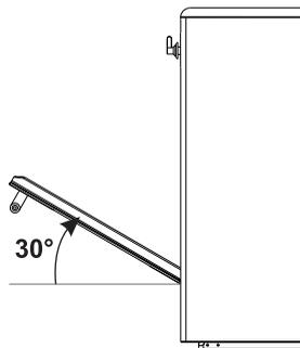
3. Per rimontare la porta inserire le cerniere nelle apposite fessure poste sul forno assicurandosi che le scanalature **A** si appoggino completamente alle fessure. Abbassare la porta verso il basso e una volta posizionata rimuovere i pernetti dai fori delle cerniere.
