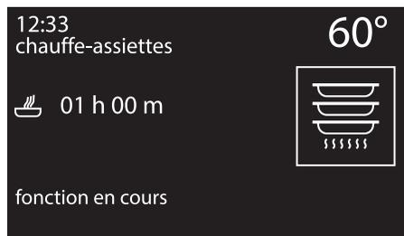
8. Au terme de la fonction, l'afficheur indique le message « fonction terminée » et un signal sonore se déclenche ; pour le désactiver, appuyez sur la manette de commande.
