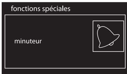
3. Tournez la manette de commande à droite ou à gauche pour régler la durée (de 1 minute à 4 heures). Au bout de quelques secondes, le symbole
