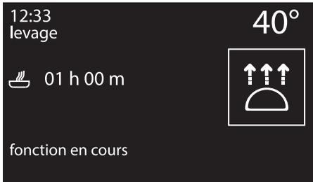
**i** Sauf réglage différent, le levage a une durée maximale de 13 heures.
