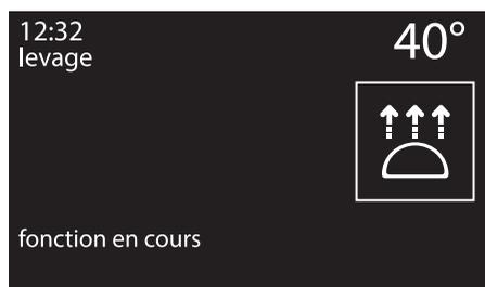
Pendant cette fonction il est possible de régler un minuteur pour 4 heures maximum (voir « Minuteur durant une fonction »), une durée de levage (voir « Cuisson temporisée ») ou un levage différé (voir « Cuisson programmée »).
