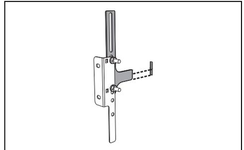
5. Die Basis des Befestigungsbügels bis zum Boden ausrichten und die Befestigungsschrauben anziehen.
