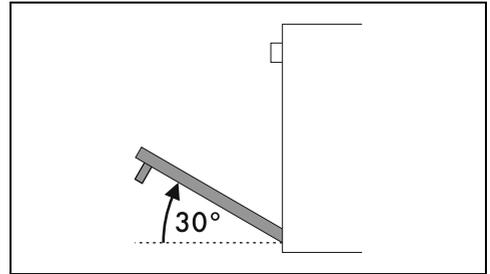
3. Zum Wiedereinsetzen der Tür müssen die Scharniere in die dafür vorgesehenen Schlitzte am Backofen eingefügt werden, wobei sichergestellt werden muss, dass die Aussparungen **A** fest auf den Schlitzten aufliegen.
