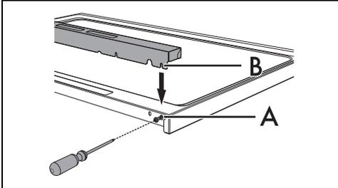
Die Aufkantung muss immer korrekt auf dem Gerät positioniert und befestigt sein.
