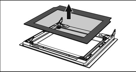
5. Die Zwischenverglasung durch Anheben entfernen.
