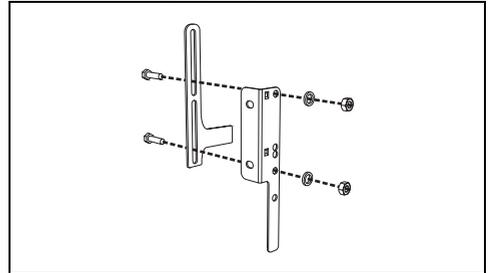
4. Die Hakenbasis des Befestigungsbügels auf die Schnittbasis der Befestigungsplatte für die Fixierung an der Mauer ausrichten.
