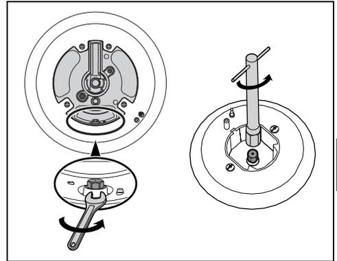
1. Gitterroste, Brennerdeckel und Brennerkränze entfernen, um auf die Brenner einwirken zu können.
