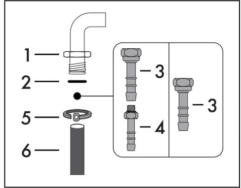
Den Schlauchnippel 3 korrekt auf den Gasanschluss 1 (Gewinde 1/2" ISO 228-1) des Gerätes schrauben und dabei die Dichtung 2 dazwischen fügen. Je nach Durchmesser des verwendeten Gasschlauchs kann auch der Schlauchnippel 4 an den Schlauchnippel 3 angeschraubt werden.
