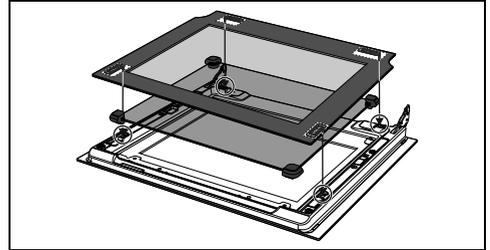
9. Darauf achten, dass die 4 Stifte der Innenverglasung in den Aufnahmen der Klappe stecken.
