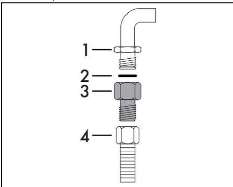
Den Anschluss 3 fest auf den Gasanschluss 1 (Gewinde 1/2" ISO 228-1) des Gerätes schrauben. Auch hier die mitgelieferte Dichtung 2 zwischen die beiden Anschlüsse legen. Isoliermaterial an dem Gewinde des Anschlusses 3 anbringen und dann den
