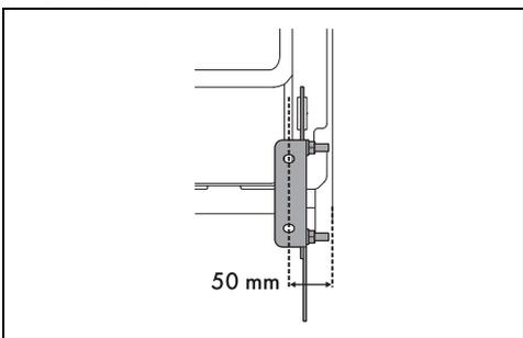
7. Den Bügel an die Wand versetzen und die Position der in die Mauer zu bohrenden Löcher markieren.
