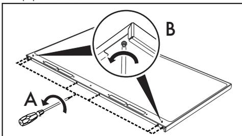
2. Positionnez le dossieret sur la plaque. Faites correspondre les 6 rainures inférieures du dossieret et les 6 vis situées à l'arrière de la plaque desserrées précédemment.
