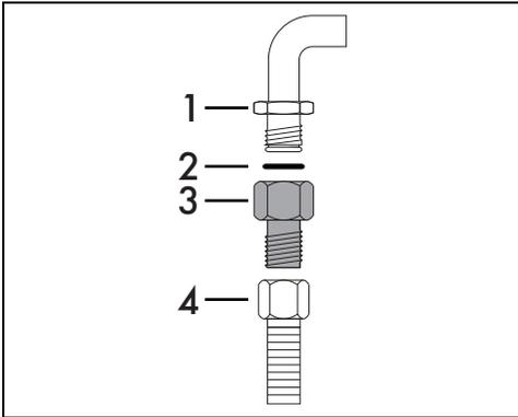
Den Anschluss 3 fest auf den Gasanschluss 1 (Gewinde 1/2" ISO 228-1) des Gerätes schrauben. Auch hier die mitgelieferte Dichtung 2 zwischen die beiden Anschlüsse legen. Isoliermaterial an dem Gewinde des Anschlusses 3 anbringen und dann den Stahlschlauch 4 an dem Anschluss 3 festschrauben.
