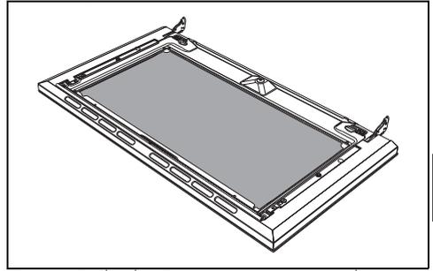
7. Am Ende des Reinigungsvorgangs die mittlere Glasscheibe erneut in die entsprechende Aufnahme in der Tür einsetzen.
