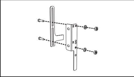
7. Den Bügel an die Wand versetzen und die Position der in die Mauer zu bohrenden Löcher markieren.
