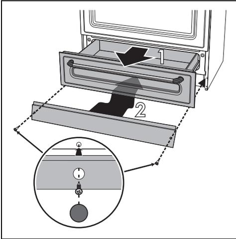
Der Sockel muss immer korrekt am Gerät positioniert und befestigt sein.
