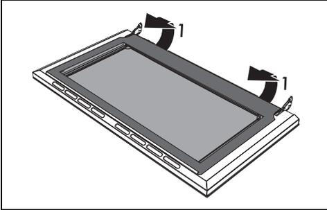
4. Die Innenscheibe aus der vorderen Leiste (2) herausziehen, um sie von der Tür zu lösen.
