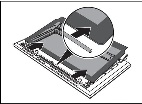
5. Die Zwischenverglasung durch Anheben entfernen.
