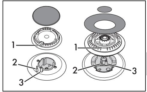
Vor dem Zünden der Brenner ist sicherzustellen, dass die Brennerkränze mit den zugehörigen Brennerdeckeln richtig in ihren Sitzen positioniert sind. Darauf achten, dass die Öffnungen 1 der Brennerkränze, die Zündkerzen 3 und die Thermoelemente 2 aneinander ausgerichtet sind.
