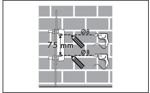
4. Die Hakenbasis des Befestigungsbügels auf die Schnittbasis der Befestigungsplatte für die Fixierung an der Mauer ausrichten.
