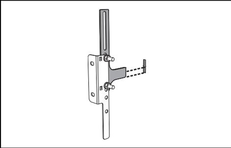
8. Nach der Bohrung der Löcher den Bügel mittels Dübel und Schrauben an der Wand befestigen.
