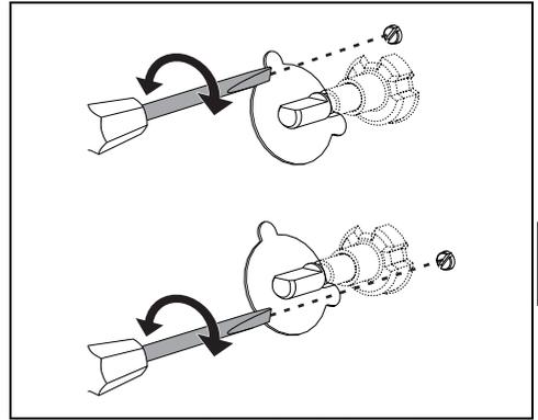
Den Brenner zünden und auf Kleinstellung setzen. Den Griff vom Gashahn entfernen und die Stellschraube regulieren, die sich neben dem Stab des Hahns befindet (je nach Modell), bis eine gleichmäßige kleinste Flamme erzielt ist. Den Griff wieder anbauen und die Stabilität der Brennerflamme prüfen. Dazu den Griff schnell von der Höchst- auf die Mindeststufe drehen: die Flamme darf dabei nicht ausgehen. Diesen Vorgang bei allen Gashähnen wiederholen.
