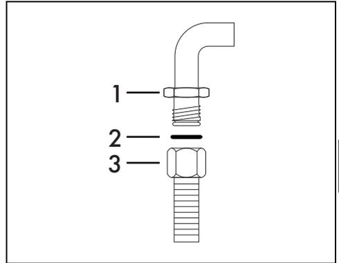
Den Anschluss 3 korrekt auf den Gasanschluss 1 des Gerätes schrauben. Zwischen dem Anschluss und dem Gasanschluss immer die mitgelieferte Dichtung 2 einsetzen.
