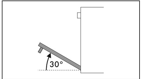
3. Zum Wiedereinsetzen der Tür müssen die Scharniere in die dafür vorgesehenen Schlitze am Backofen eingefügt werden, wobei sichergestellt werden muss, dass die Ausparungen **A** fest auf den Schlitzen aufliegen.
