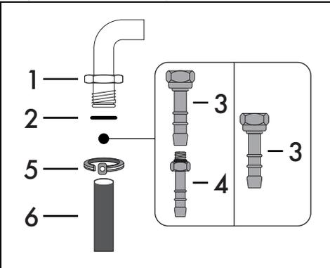
Den Schlauchnippel 3 korrekt auf den Gasanschluss 1 (Gewinde 1/2" ISO 228-1) des Gerätes schrauben und dabei die Dichtung 2 dazwischen fügen. Je nach Durchmesser des verwendeten Gasschlauchs kann auch der Schlauchnippel 4 an den Schlauchnippel 3 angeschraubt werden.
