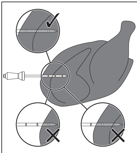
Para una medida precisa de la temperatura en el centro de la comida, la punta de la sonda no debe entrar en contacto con huesos o partes grasas.
