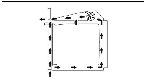
El ventilador procede a enfriar el aparato y entra en funcionamiento durante la cocción. El funcionamiento del ventilador crea un flujo de aire normal que sale por arriba de la puerta y puede seguir saliendo durante un breve período aun después de apagar el aparato.
