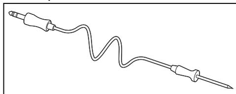
Con la sonda de temperatura se puede realizar una cocción en función de la temperatura que mide la sonda en el centro del alimento.
