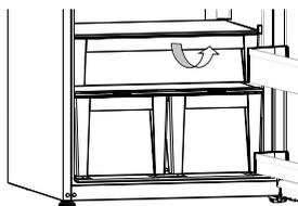
Depois de ter sido retirada a prateleira de refrigeração, esta pode suportar uma carga com um máximo de 20 kg.
