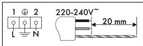
Cavo tripolare 3 x 1,5 mm<sup>2</sup>.
